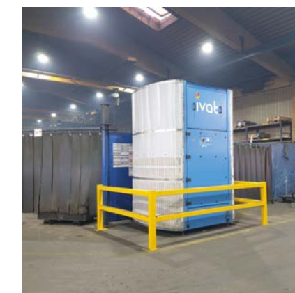
Der neue Filterturm in der Hefterei spart gegenüber einer Prozessluftanlage etwa 70 Tonnen CO 2 .
